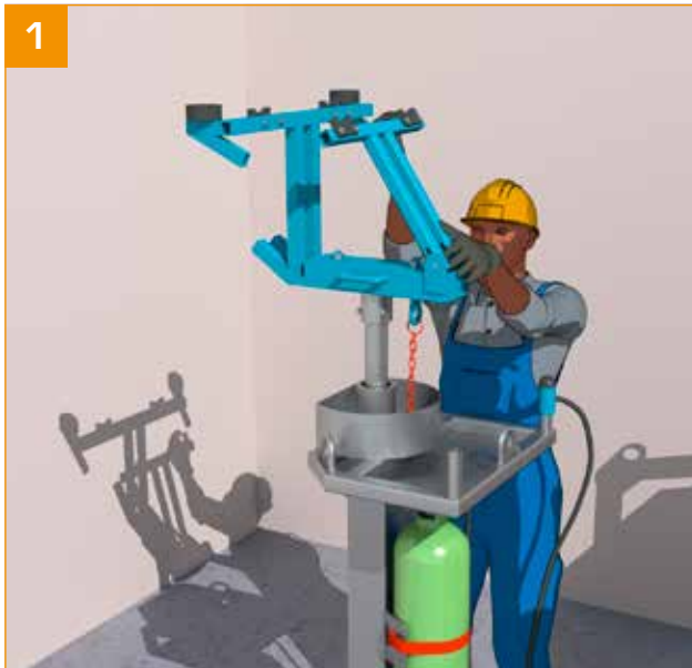
1 - Klappen Sie den hinteren Arm des MaxUp aus und verriegeln Sie ihn.
