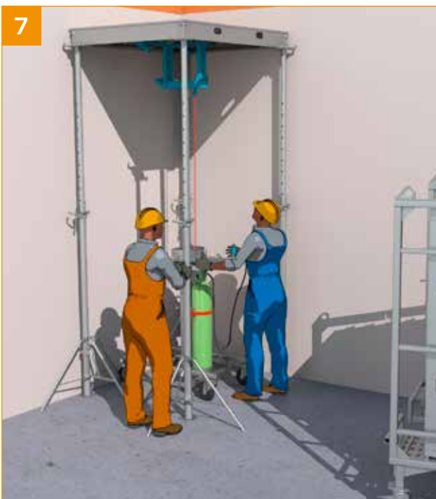
7 - Platzieren Sie die 4 Stützen jeweils mit Dreibein an den 4 Ecken des Panels.
