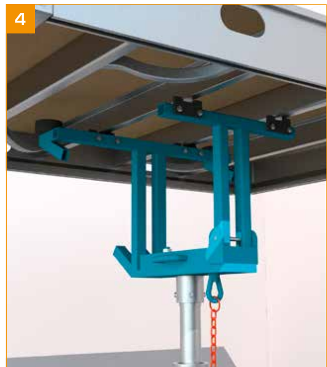
4 - Die beiden Profile in der Mitte des Paneels liegen auf den Puffern auf.
